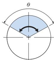
※摇摆角度： $\theta$ 较小时，轨道圈和滚子的接触面难以形成油膜，可能发生微动磨损。如要以这种条件使用时，请咨询THK。
