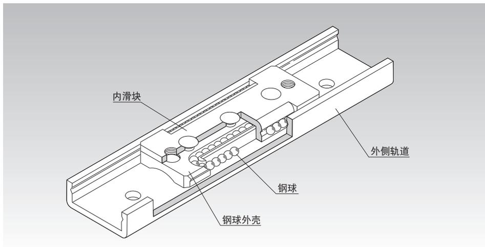
图1 精密板式直线导轨ER型的结构
